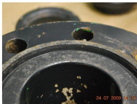
Revestimento interno da tampa com incrustação
