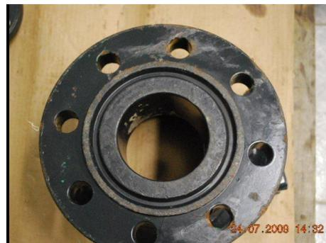
Revestimento interno da tampa intacto
