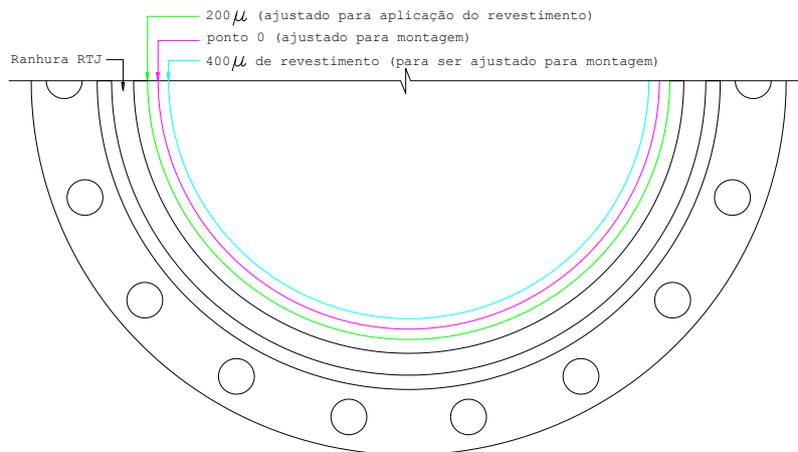
No passo seguinte a válvula segue para a aplicação do revestimento.
