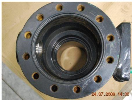
Revestimento interno do corpo intacto
