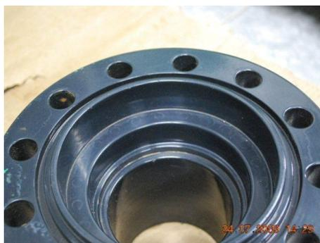
Revestimento interno da tampa intacto
