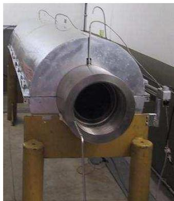
Figura 6 – Teste de absorção de água para amostras de PP sintático retiradas de tubo revestido
