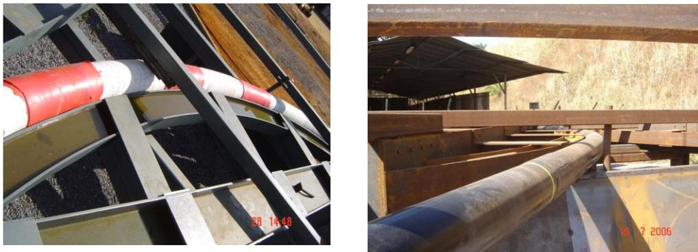
Figura 4 – Teste de dobramento em escala real do tubo e da junta de campo
