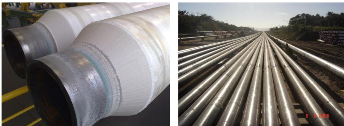
Figura 1 – Revestimento anticorrosivo e térmico dos oleodutos e anticorrosivo do gasoduto
