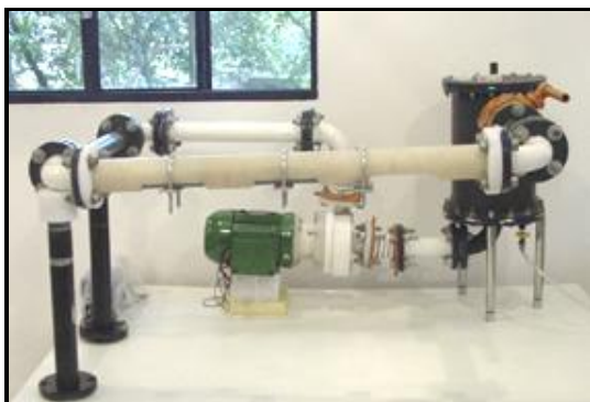
Figura 5 – Um dos loops do Laboratório de Corrosão e Proteção, utilizado nos ensaios
