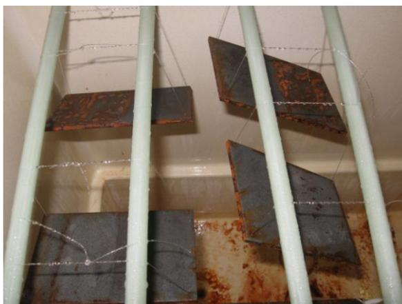
Figura 11- Amostras fixadas em ângulo de 15° a 30° com a horizontal após o ensaio de névoa salina.
