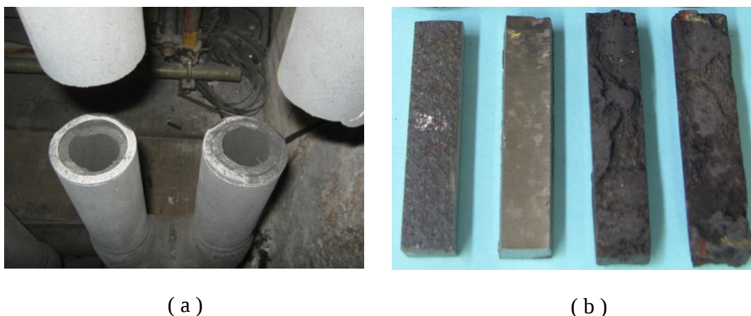
Figura 5 - Tubo com coque interno: (a) aspecto do coque interno ao tubo (b) Corpos de prova preparados a partir de metal e coque para realização de análise dilatométrica [13].
