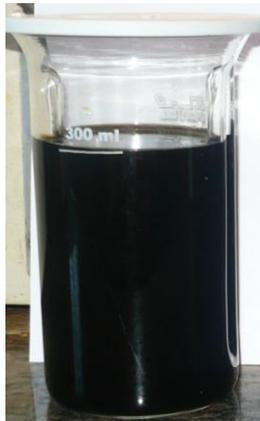
**Figura 6.** Acetonitrila degradada e contaminada com compostos corrosivos e produtos da corrosão.
