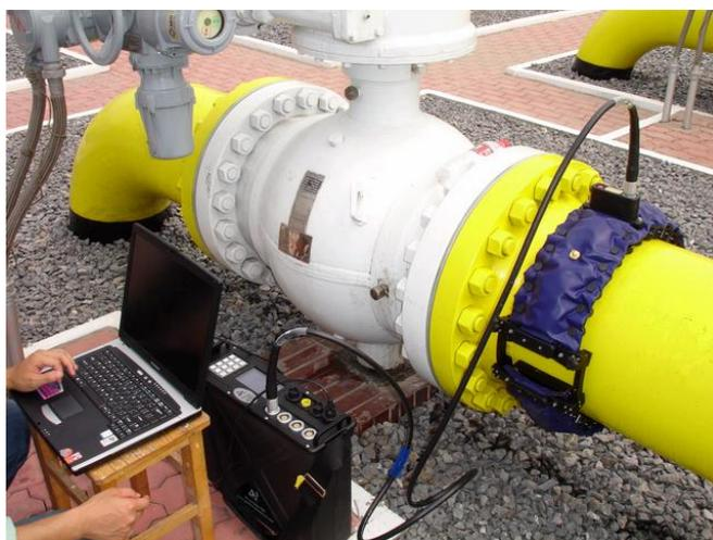
**Figura 18** – Equipamento completo para ondas guiadas
