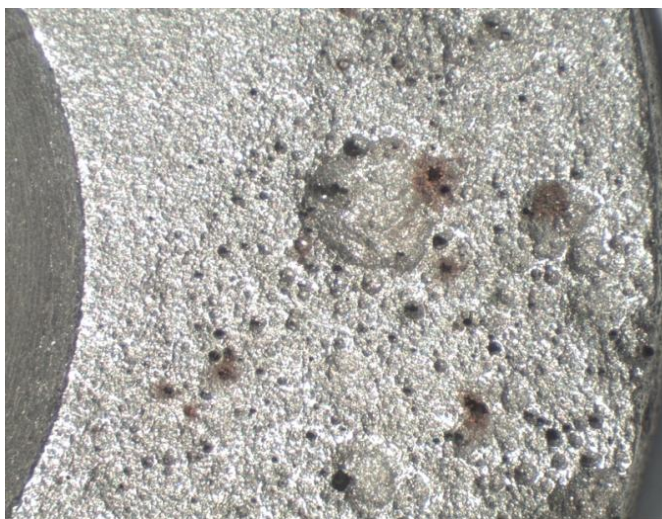
Figura 07 – Pites presentes no cupom retirado em 29/01/2009 no duto “A”
