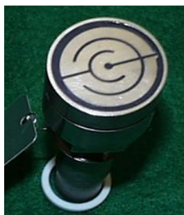
Figura 03 – Sonda de resistência elétrica
