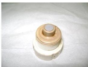
**Figura 1 – Suporte com o corpo de prova**
