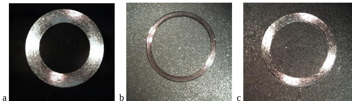
FIGURA 6 - Microscopia óptica para comparação qualitativa das trilhas de desgaste do substrato (a), sistema carbonetado (b) e sequencial (c).
