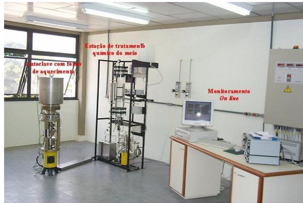
**Figura 2** – Instalação para ensaios de corrosão sob tensão.
