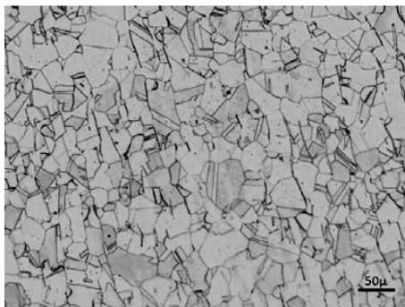
**Figura 5** – Micrografia do aço inoxidável austenítico AISI 316L.
