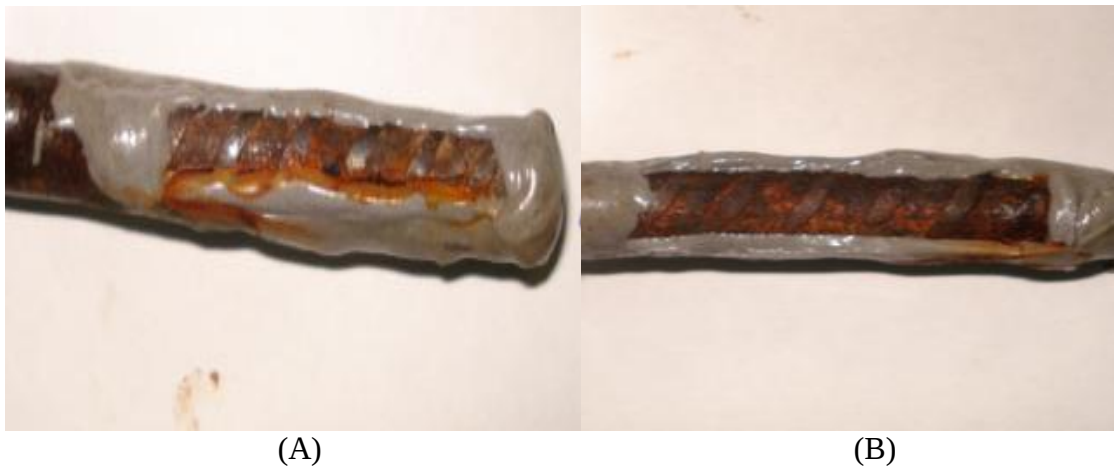
Figura 4: Imagem do ensaio de névoa salina do silano obtido a partir dos precursores TMSPMA e TEOS, (A) substrato com pré-tratamento, (B) substrato sem pré-tratamento.
