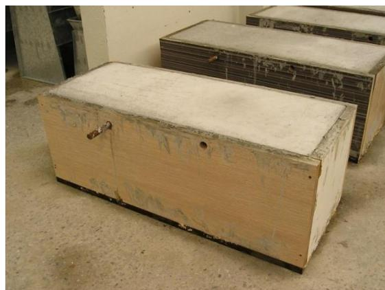
Figura 5. Corpos-de-prova após o processo de cura. Os corpos-de-prova foram mantidos nas fôrmas e no local de moldagem devido ao peso do material, estimado em cerca de 100kg.
