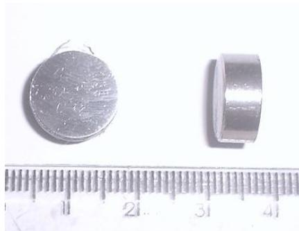
Figura 4: Pastilhas cilíndricas confeccionadas de aço inoxidável AISI 304L
