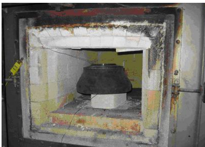
Figura 8 – Tratamento térmico do bocal de aço A508.
