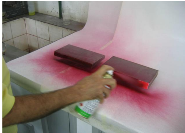
Figura 2 – Corpos de prova para qualificação do procedimento de soldagem sendo ensaiados por Líquido Penetrante.
