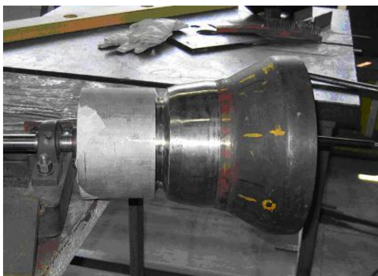
Figura 10 – Detalhe mostrando o tubo de aço inox a ser soldado ao safe end.
