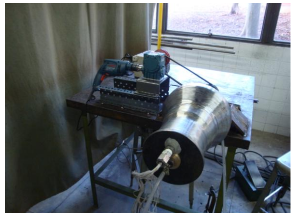
(b) Sistema para girar o mock up durante a deposição da sobrecamada de solda
