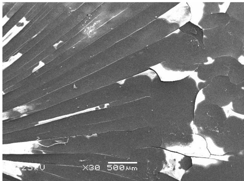
Figura 12. Imagem em MEV do filme depositado sobre substrato de Al anodizado, aumento de 30x.
