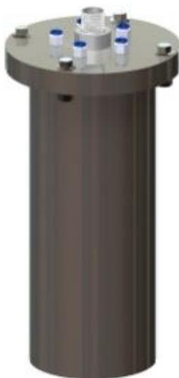
Figura 1 – Desenho representativo do reator eletroquímico.
