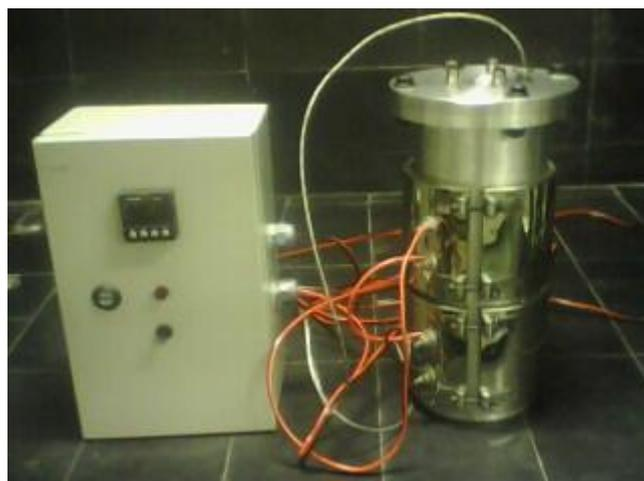
Figura 3 – Reator eletroquímico e sistema de aquecimento com controlador de temperatura.
