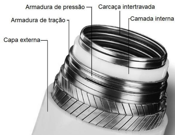
**Figura 1 - Típica seção transversal de um tubo flexível (5,6).**
