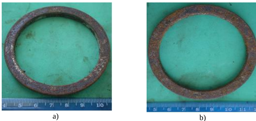
Figura 1 - a) Cupom CPM 01 e b) Cupom CPM 02 após a retirada da coluna de produção para análise, antes da decapagem.
