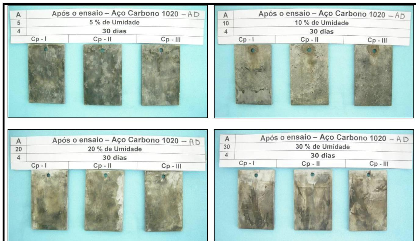
**Figura 6.** Aspecto visual dos corpos-de-prova após ensaios de perda de massa [4]
