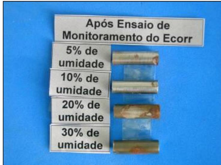
**Figura 4.** Aspecto visual dos corpos-de-prova após ensaio de Ecorr vs tempo
