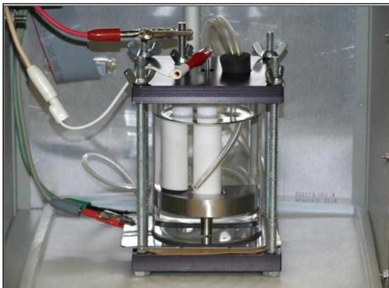
**Figura 1.** Gaiola de Faraday com a “célula de Tait” e os três eletrodos conectados eletricamente aos terminais do potenciostato.
