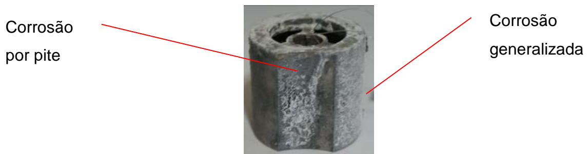
Figura 3 - Peça em Zamac após o ensaio em névoa salina
