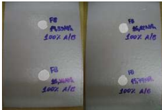
Figura 7 - Teste de aderência por tração
