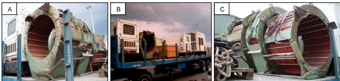
Figura 1. Equipamento de aquecimento indutivo. Geradores, painéis e bobinas.
