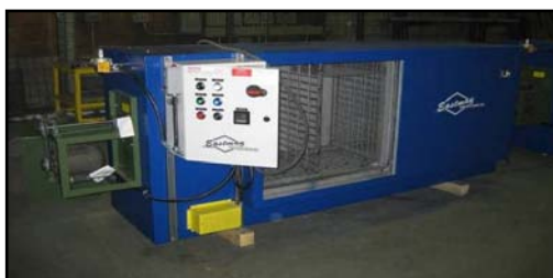
Figura 4. Estufa de pré-aquecimento dos materiais de revestimento de juntas de campo.
