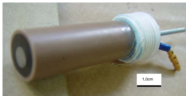
Figura 2 – Fotografia do eletrodo de trabalho de aço carbono (SAE1020) utilizado no estudo.
