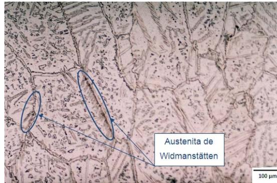
**Figura 8 - Austenita de Widmanstätten, amostra A1, região ZF, ataque eletrolítico em ácido oxálico (10%)**
