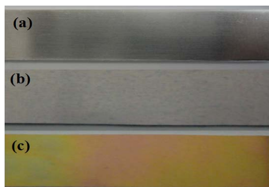
Figura 2. (a) Aspecto da superfície da liga de alumínio 5052 (a) sem tratamento (b) após o processo de silanização e (c) após a cromatização hexavalente.
