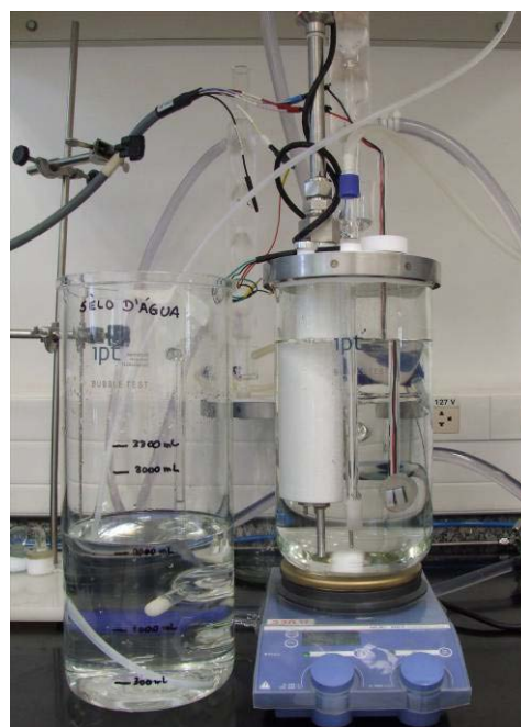
Ensaio de medição de corrente galvânica
