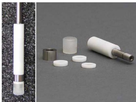
Figura 1. A composição do eletrodo cilíndrico rotativo (ECR). Fonte: Pine Research
