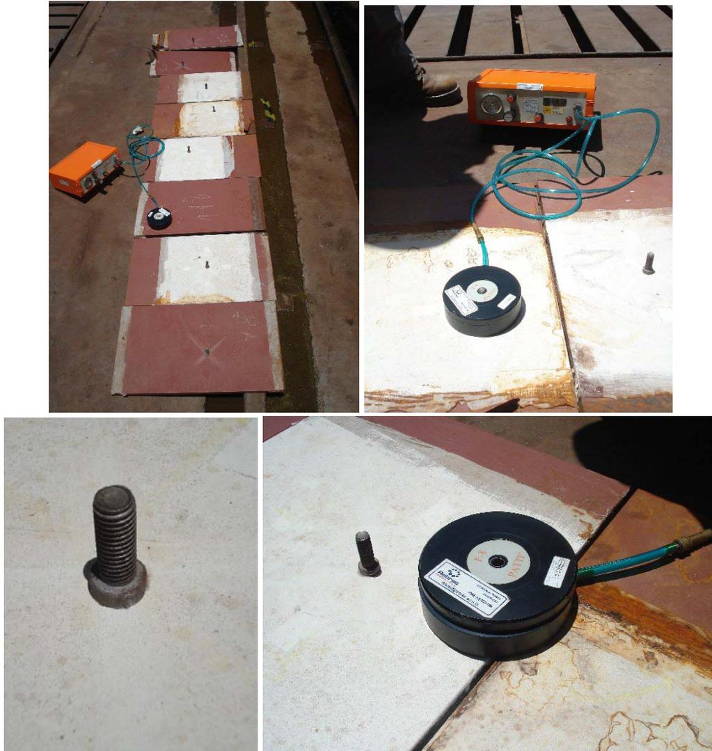
Os resultados indicam não haver nenhuma influência sobre a aderência da tinta, quando comparado com e sem aditivo. Para ambos os casos os resultados em números absolutos do equipamento foram superiores a 100 PSIG, demonstrando estar acima da especificação da Petrobrás.
