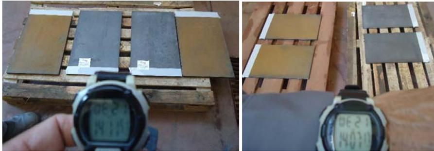
Os resultados demonstraram que após 2hs as chapas hidrojetadas com água já se apresentavam totalmente oxidadas (o processo de oxidação inicia logo após à aplicação, observando manchas enquanto seca a superfície), enquanto as hidrojetadas com o 1712 SPH mantiveram-se sem oxidação por até 48hs. As amostras foram mantidas no ambiente úmido das salas de hidrojetamento.
