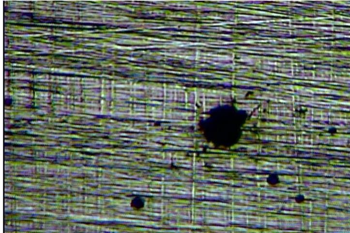
**Figura 11 – Pite formado na superfície da Tesoura C após ensaio de polarização em solução de detergente enzimático (Aumento de 730 x).**
