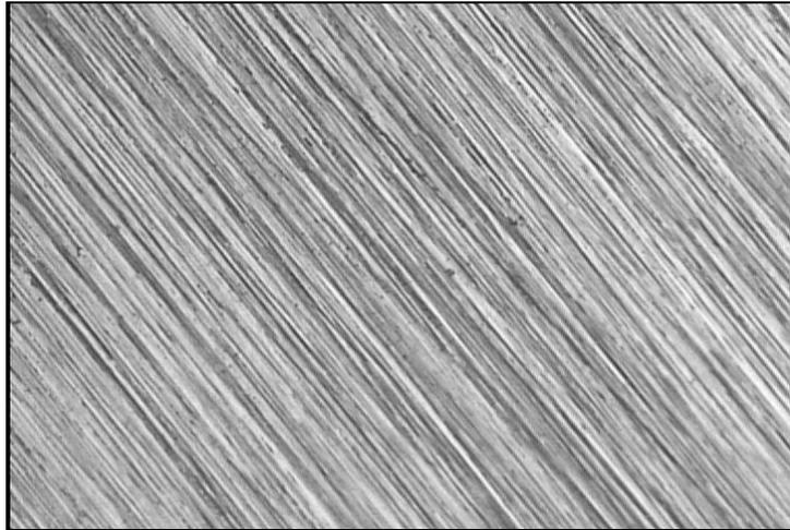
**Figura 9 – Superfície do Afastador B após ensaio de polarização em solução de detergente enzimático. (Aumento de 730 X).**
