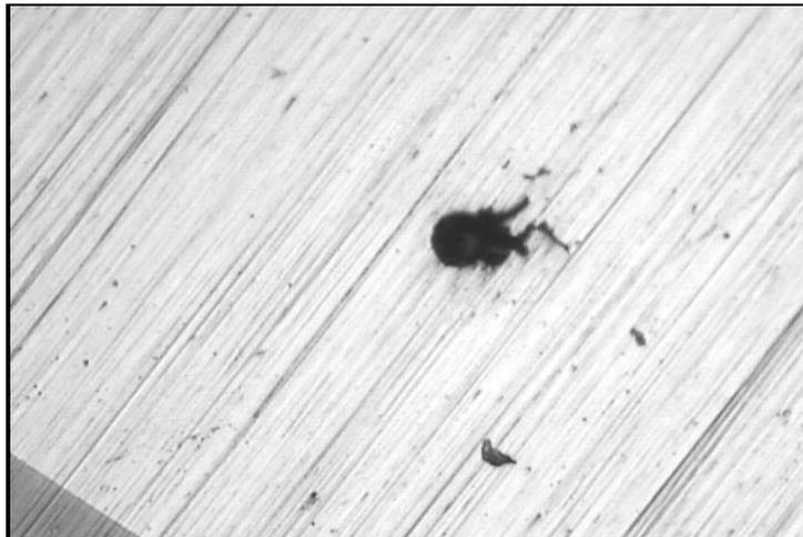
**Figura 6 – Pite formado na superfície do Afastador A após ensaio de polarização com solução de detergente enzimático (Aumento de 1460 x).**
