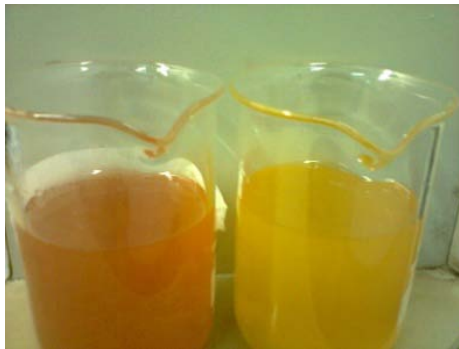
Figura 7 - Aparência final do ensaio na autoclave com Imidazolina.
