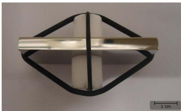
**Figura 1 – Montagem do corpo de prova para os ensaios de corrosão por frestas.**
