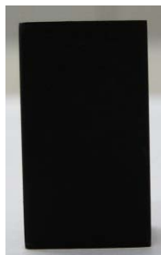
Figura 8 - Aço carbono, teste branco, após 7 dias em reator.
