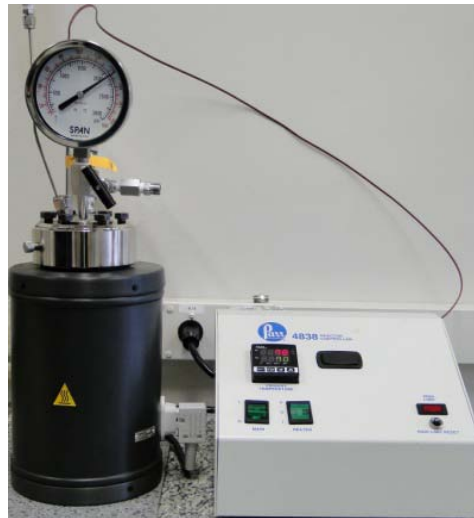
Figura 1 - Reator Parr utilizado para realização dos experimentos.
