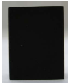
Figura 11 - Aço carbono com tanino em solução desoxigenada.
