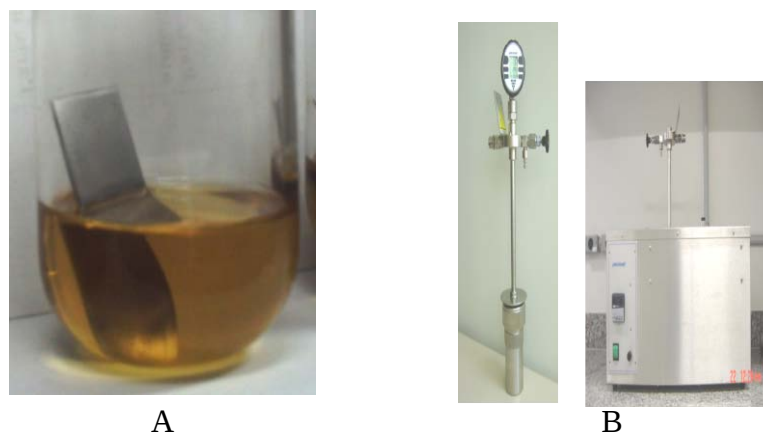
Figura 1. Corpo de prova parcialmente imerso em amostra combustível (A), em autoclave individual (B).
