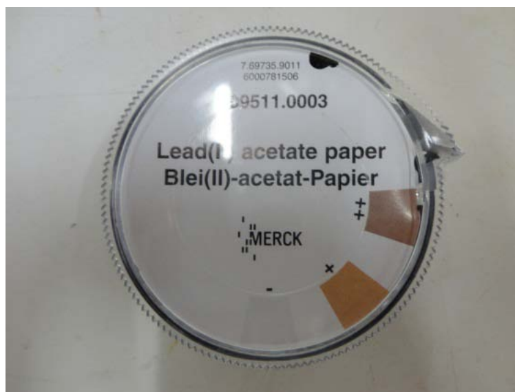
Figura 2: Papel acetato de chumbo utilizado para auxiliar na interpretação das curvas de titulação potenciométrica.
