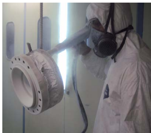
Figuras 11 e 12. Aplicação do ECTFE em pó via EPC.
