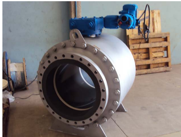
Figura 18. Válvula montada após aplicação do revestimento de ECTFE
