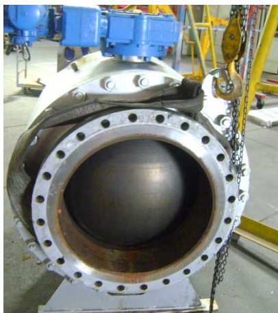
Figura 14. Recebimento da válvula montada. Notar pontos de oxidação na parte interna, ao lado do assento da esfera.
