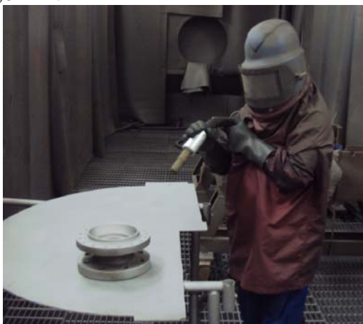
Figura 7. Jateamento da peça após desmontagem e limpeza
