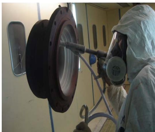
Figuras 11 e 12. Aplicação do ECTFE em pó via EPC.
