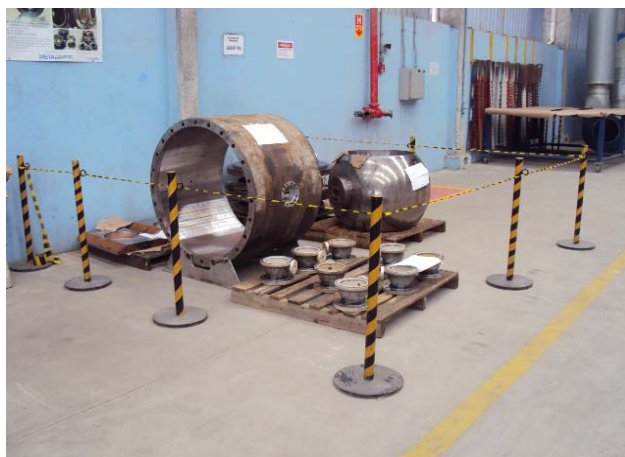
Figura 15. Equipamento desmontado para adequação pré-jateamento.
