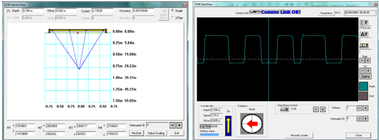
Figura 10 – Vetores de localização do duto e sinal da corrente chaveada padrão <0> no retificador de proteção catódica. Centro do Sensor Bar localizado sobre a geratriz superior do duto no km (0 + 040) e corrente injetada no retificador de proteção catódica igual a 4,6 A chaveada no padrão <0>
