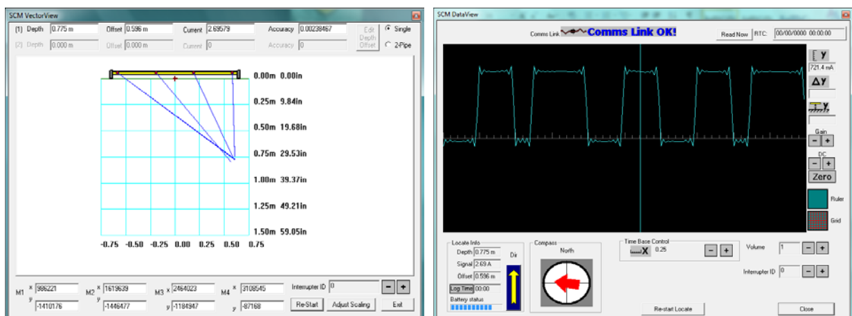
Figura 8 – Vetores de localização do duto e sinal da corrente chaveada padrão <0> no retificador de proteção catódica. Centro do Sensor Bar localizado a 50 cm a esquerda da grateriz superior do duto.
