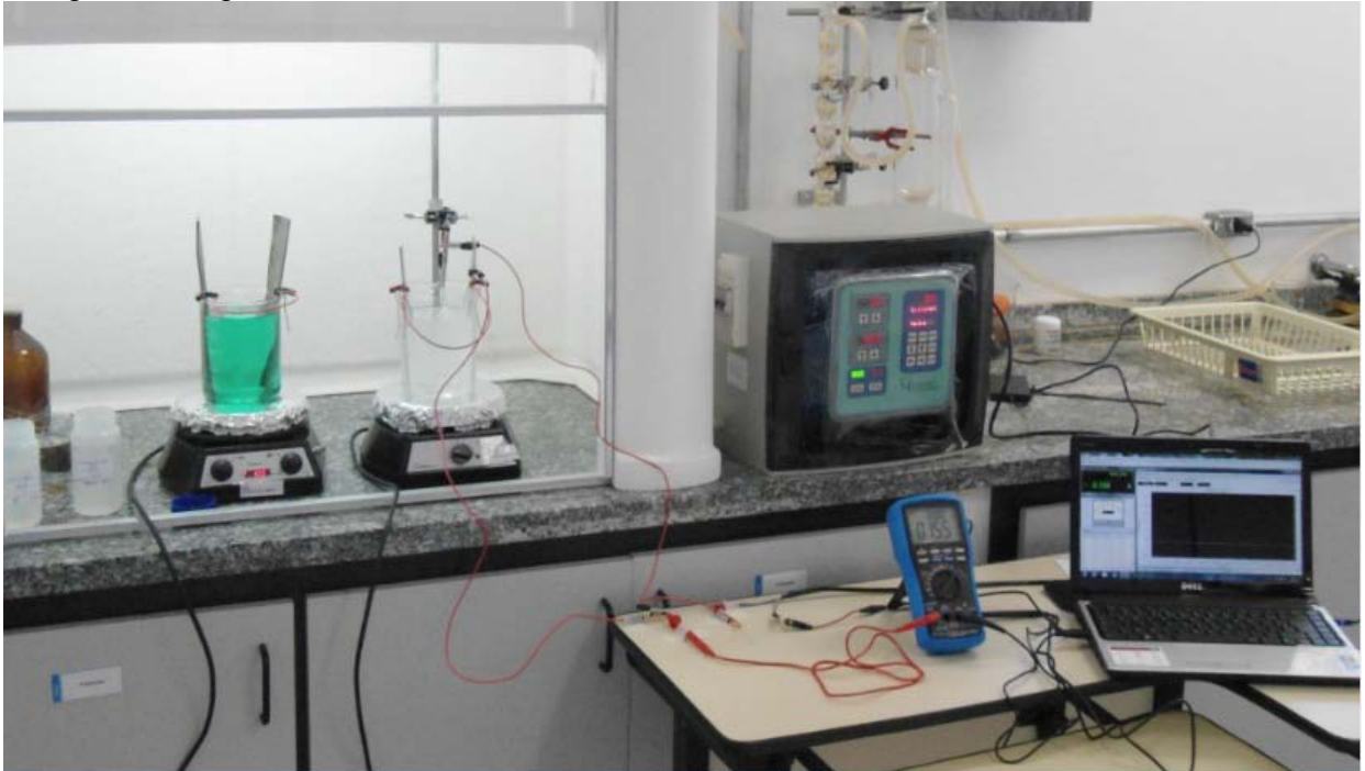
Figura 1 - Montagem do sistema de anodização
