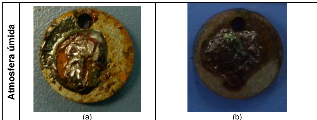
Figura 8 – Imagem macroscópica do cp após ensaio em atmosfera úmida (a) com borbulhamento de CO 2 (b) com borbulhamento de N 2
