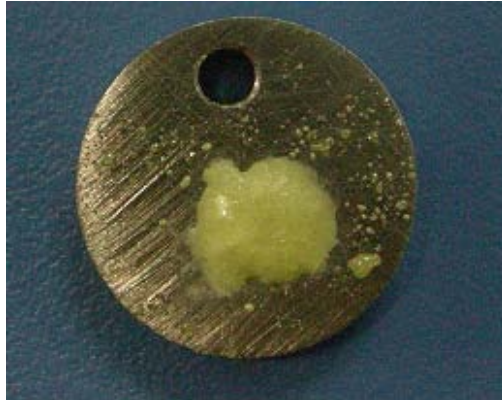
Figura 2- Corpo-de-prova dos ensaios de simulação de linhas de transporte
