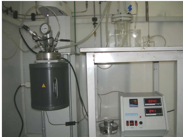
Figura 1 – Ensaios de Imersão para simulação de linhas de produção
