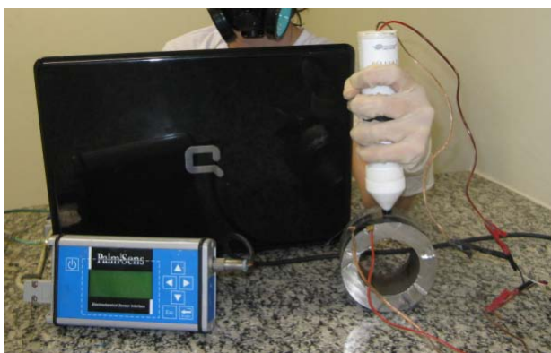
Figura 1. Célula eletroquímica desenvolvida pelo ENGESOLDA.
