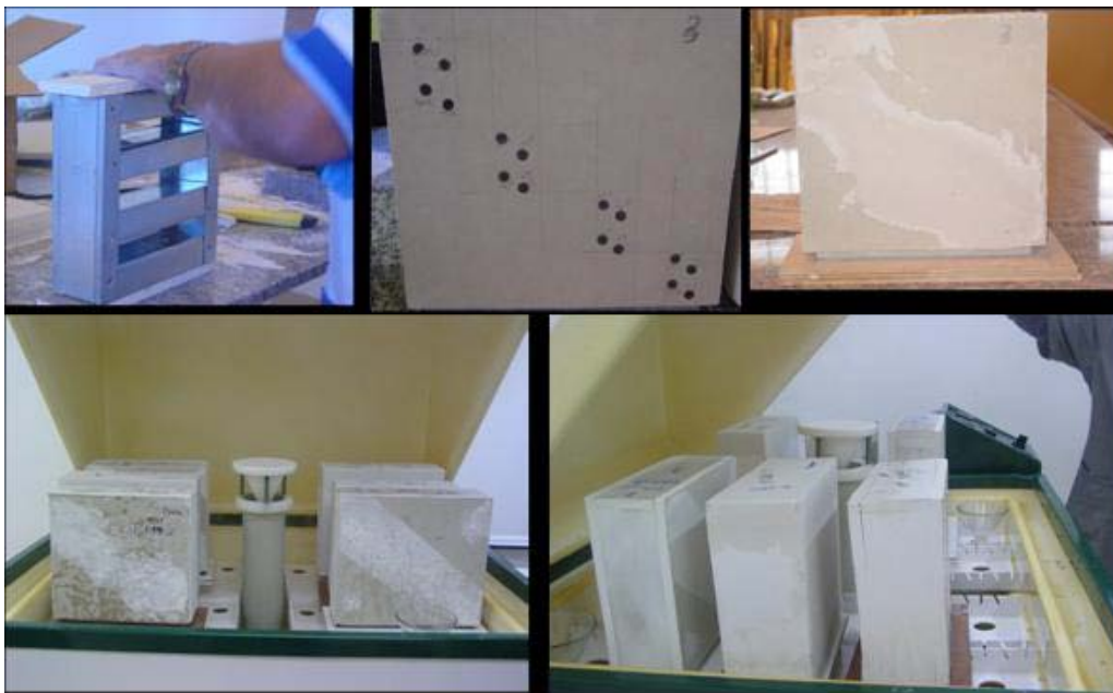
Figura 3 - Montagem dos protótipos com chapas de gesso e posicionamento no interior da câmara de névoa salina neutra
