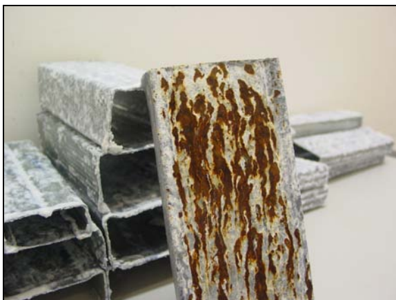
Figura 5 – Ilustração com exemplo de corrosão vermelha no perfil após exposição em câmara de névoa salina neutra
