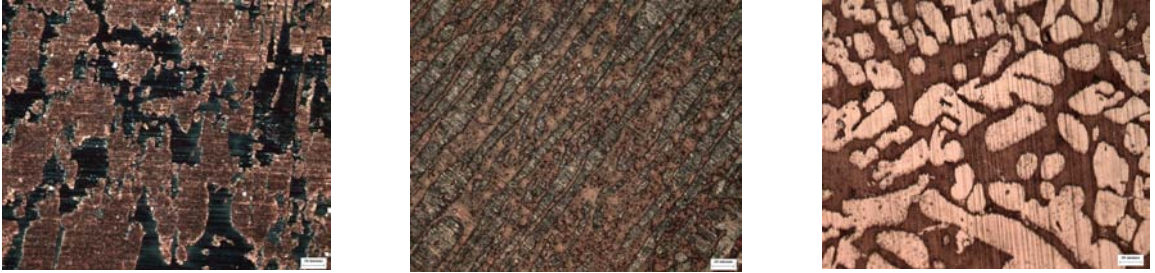
Figura 5 - Microestrutura revelada após polarização potencioestática.
