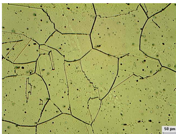
Figura 7 - Microestrutura de uma região próxima ao cordão de solda apresentando uma maior quantidade de precipitados.
