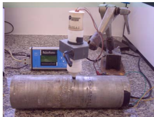
Figura 2 - Ensaio EPR-DL realizado de forma não destrutível.
