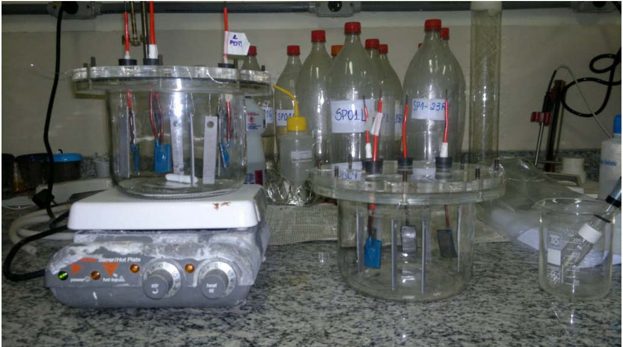
Figura 5 – Cupons de perda de massa e corpos-de-prova para acompanhamento de Potencial Eletroquímico anteriormente ao início dos experimentos: à esquerda observa-se a cuba montada para experimento sob agitação e à direita, cuba montada para experimento sob estagnação.
