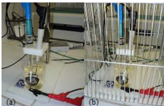
Figura 1 - Fotografias das células eletroquímicas (a) sem Gaiola de Faraday e (b) com a Gaiola de Faraday, respectivamente.
