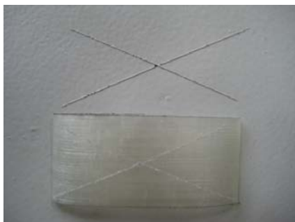
Figura 2 - Fotografia do ensaio de Aderência em X.
