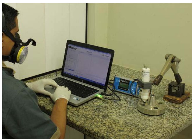
Figura 2 - Ensaio EPR-DL realizado de forma não destrutível.
