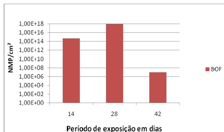
Figura 4 - Quantificação de BOF na superfície do cupom de aço carbono AISI 1010
