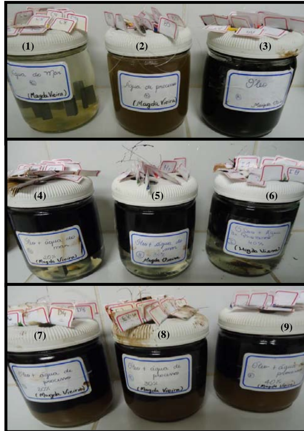
Figura 1 - Sistemas estáticos contendo fluido teste: (1) água do mar; (2) água de processo; (3) óleo; (4) água do mar + óleo (20% v/v); (5) água do mar + óleo (30% v/v); (6) água do mar + óleo (40% v/v); (7) água de processo + óleo; (20% v/v); (8) água de processo + óleo (30% v/v) e (9) água de processo + óleo.
