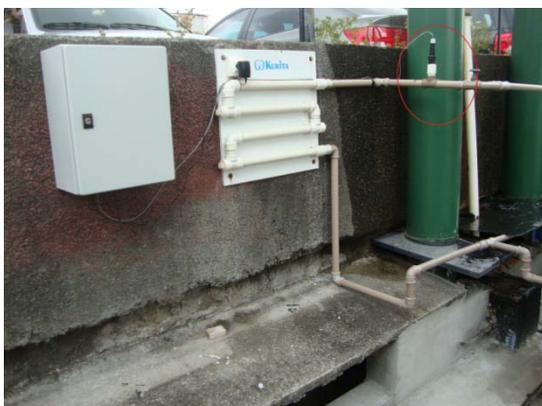
Figura 2 – Sonda corrosimétrica instalada na entrada da árvore de corpo de prova
